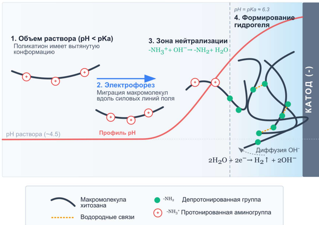
Рисунок 1. Схема механизма электроосаждения хитозанового гидрогеля на катоде: 1 — макромолекулы в объёме раствора; 2 — электрофоретическая миграция; 3 — депротонирование в зоне нейтрализации; 4 — формирование сетки гидрогеля.
